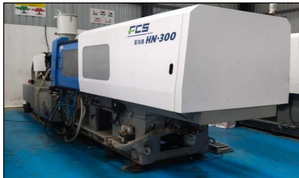
Moulding Machine -300 ton
