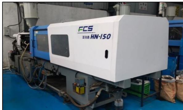
Moulding Machine -150 ton
