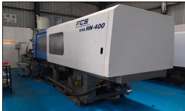
Moulding Machine -400 ton
