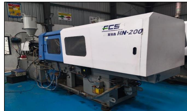
Moulding Machine -200 ton
