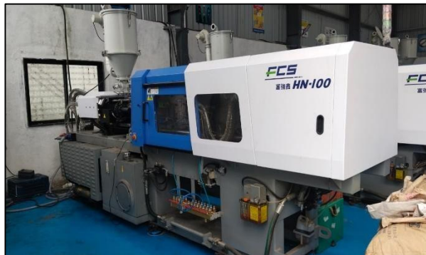
Moulding Machine - 100 ton
