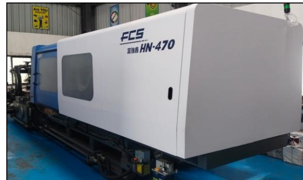
Moulding Machine -470 ton
