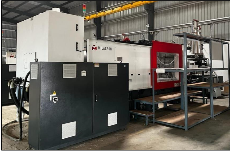
Moulding Machine - 950 ton
