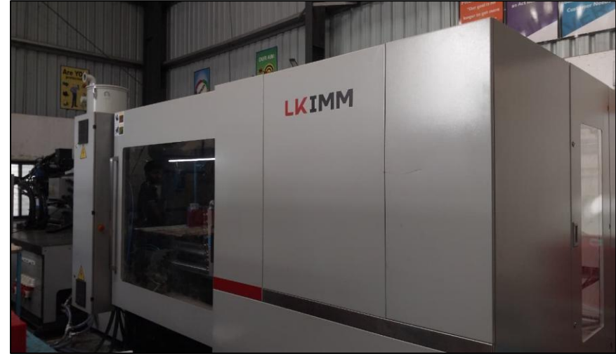
Moulding Machine - 650 ton
